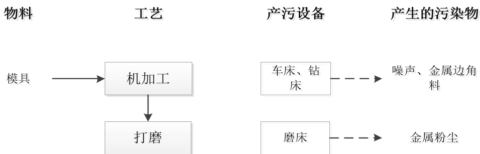
图 2.5-4 模具维修工艺流程及产污环节图
